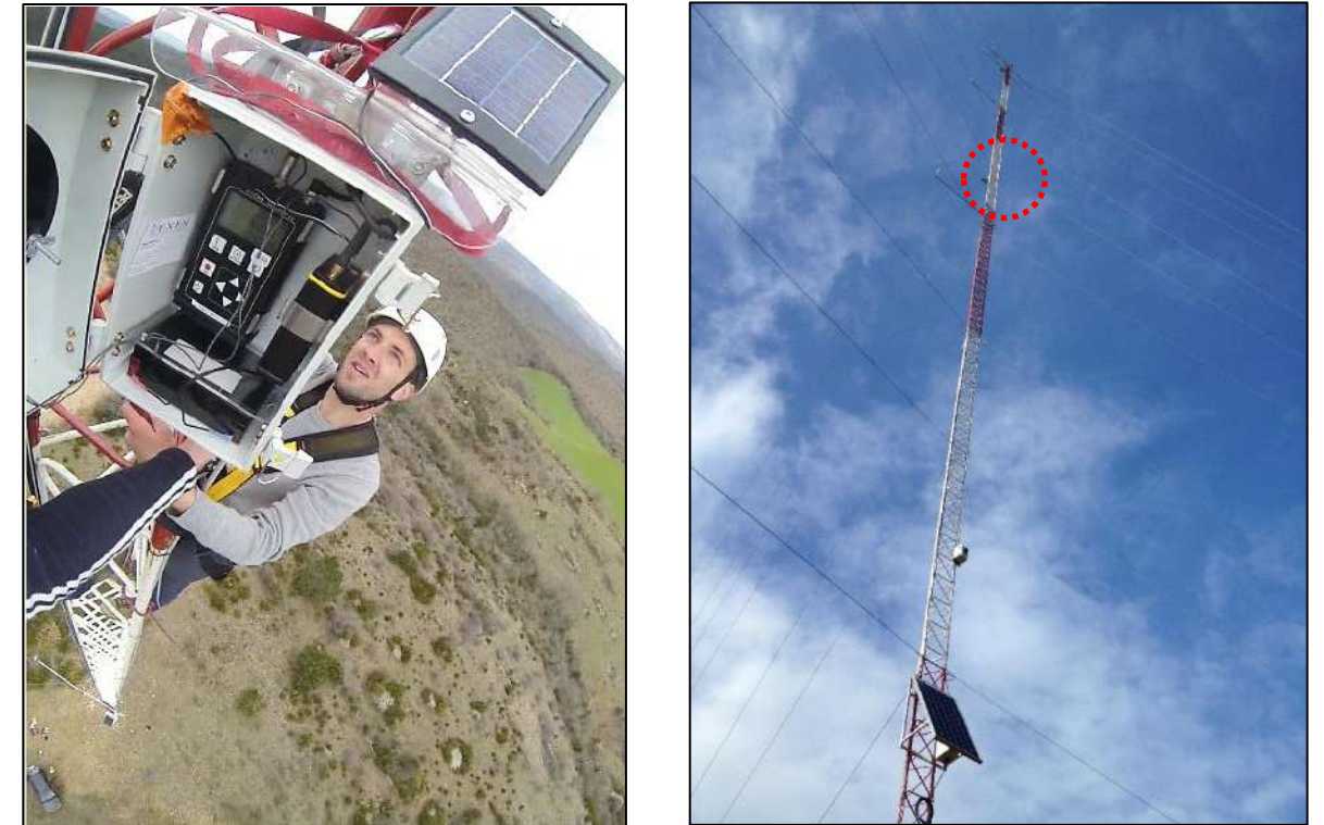
Figure 29 : Modules « BC Box » du Batcorder installés sur un mât de mesure
